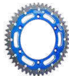
REAR SPROCKET STEEL / ALU 7289 Z48 6533 Z49 7290 Z50 7410 Z51
